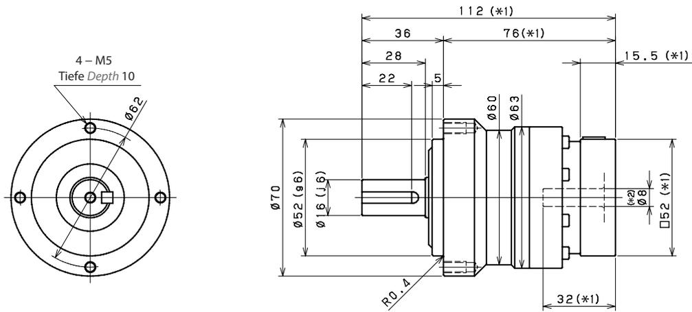
**Antriebsseitige Lochgröße *Input bore size*  $\leq \varnothing 14$  mm**
