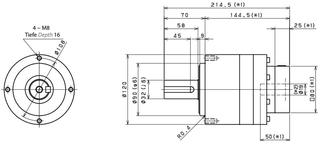
**Antriebsseitige Lochgröße *Input bore size*  $\leq \varnothing 28$  mm <sup>(\*3)</sup>**
