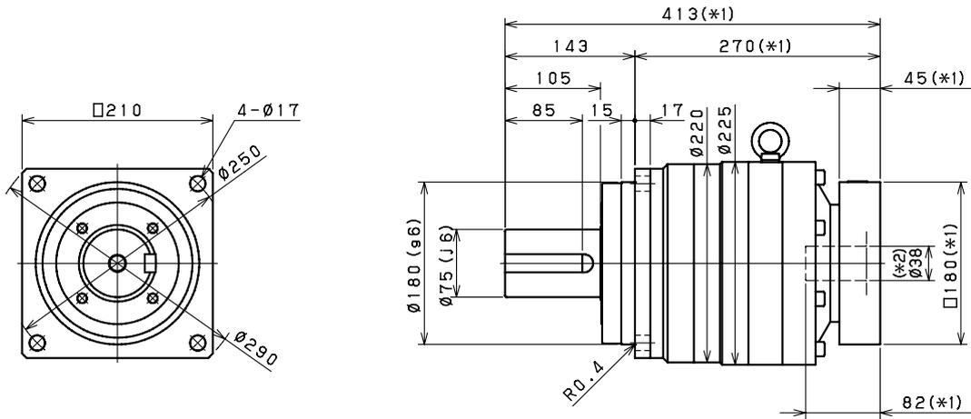
**Antriebsseitige Lochgröße Input bore size  $\leq \varnothing 48$  mm**
