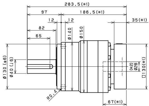
Antriebsseitige Lochgröße Input bore size  $\leq \varnothing 38$  mm (\*3)
