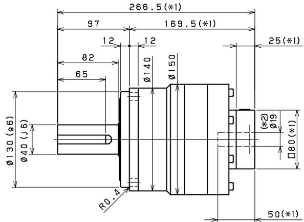
Antriebsseitige Lochgröße Input bore size  $\leq \varnothing 28$  mm
