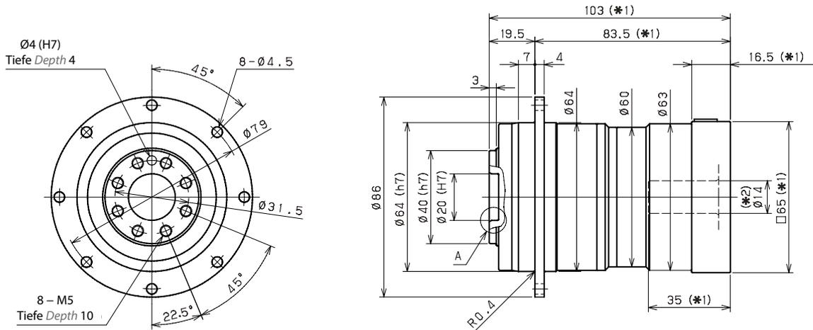
Antriebsseitige Lochgröße Input bore size  $\leq \varnothing 19 \text{ mm}$
