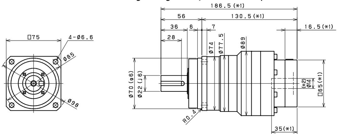
**Antriebsseitige Lochgröße *Input bore size*  $\leq \varnothing 19$  mm <sup>(\*3)</sup>**
