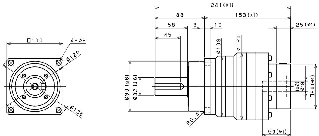
**Antriebsseitige Lochgröße *Input bore size*  $\leq \varnothing 28$  mm (\*3)**
