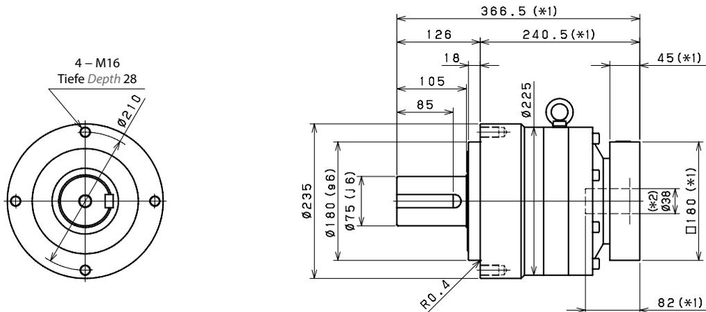
**Antriebsseitige Lochgröße *Input bore size*  $\leq \varnothing 48$  mm**
