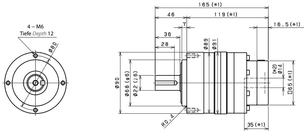
**Antriebsseitige Lochgröße Input bore size  $\leq \varnothing 19$  mm <sup>(\*)3</sup>**
