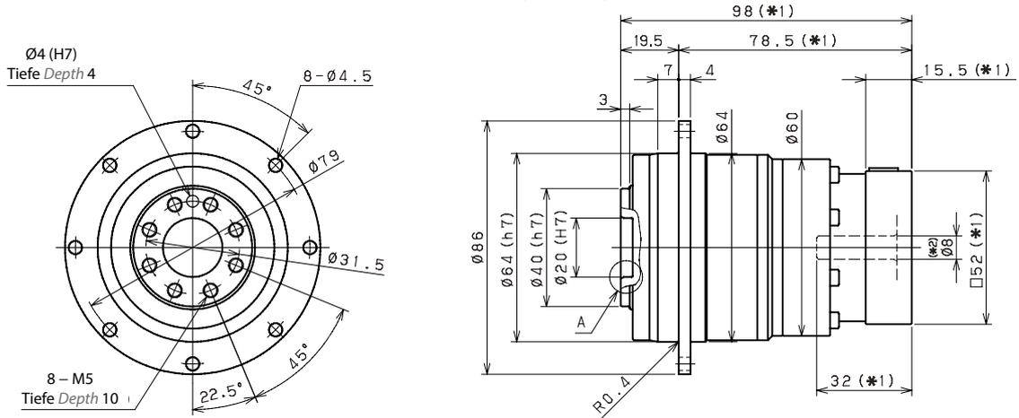
Antriebsseitige Lochgröße Input bore size  $\leq \varnothing 14 \text{ mm}$
